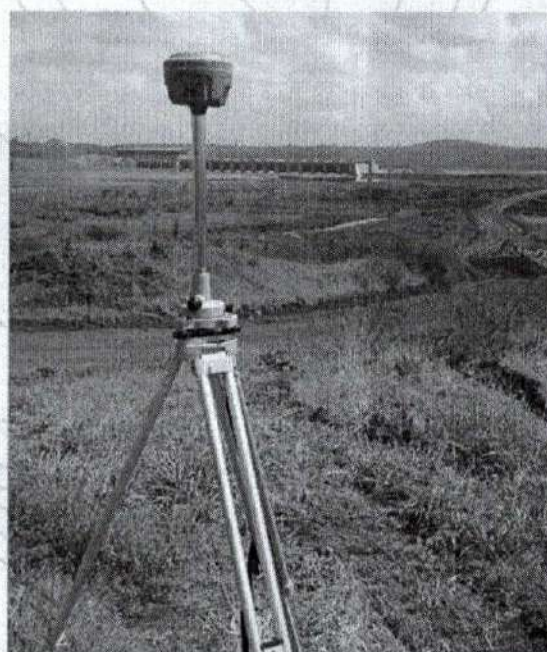
Demarcação do reservatório da UHE Baixo Iguaçu, pela empresa CKTR.
